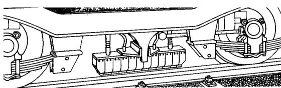
Bei Trams werden Elektromagnete als zusätzliche Bremsen verwendet (siehe Bild). Solange der Strom für diese Bremsen nicht eingeschaltet ist, werden sie von starken Federn dicht über der Schiene gehalten. Wie funktioniert eine solche Magnetschienebremse?
