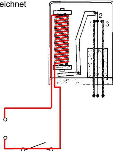
Wenn ein Strom durch die Spule fliessst wird sie magnetisch und zieht den Eisenanker an.
