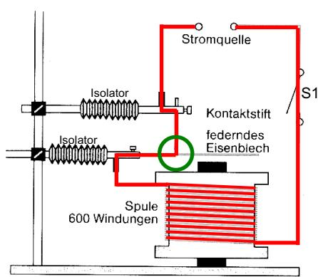
d) Der Klingelknopf wird gedrückt → der Stromkreis ist geschlossen → der Elektromagnet erzeugt ein Magnetfeld → das Eisenblech wird angezogen → das Eisenblech berührt den Kontaktstift nicht mehr → der Stromkreis wird an der Kontaktstelle unterbrochen → der Elektromagnet verliert seine Wirkung → das Eisenblech wird nicht mehr angezogen und feder zurück → der Stromkreis wird geschlossen → der Elektromagnet erzeugt ein Magnetfeld → das Eisenblech wird angezogen → etc.
