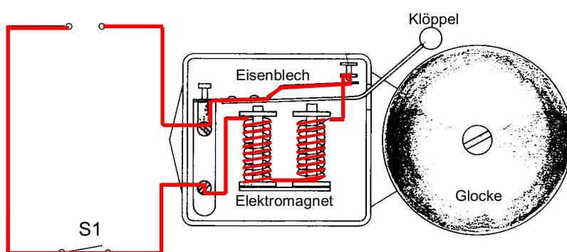
Die Spule ist ein Elektromagnet. Sie erzeugt ein Magnetfeld, wenn sie von einem Strom durchflossen wird.
