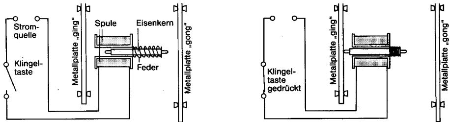
6. Ein Relais ist ein Schalter, mit dem man einen Stromkreis schliessen oder unterbrechen kann. Bei einem Relais werden die Kontakte nicht von Hand, sondern mit Hilfe eines Elektromagneten geöffnet und geschlossen.
