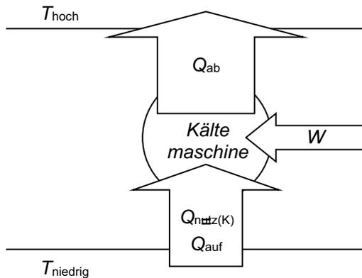
Hier fließen die Arbeit  $W$  und die am kalten Ort aufgenommene Wärme  $Q_{\text{auf}} = Q_{\text{nutz(K)}}$  in die Kältemaschine hinein, summieren sich dort und fließt dann als  $Q_{\text{ab}}$  aus der Kältemaschine heraus, und wird am warmen Ort abgegeben.
