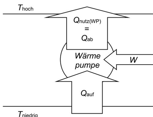
Hier fließen die Arbeit  $W$  und die am kalten Ort aufgenommene Wärme  $Q_{auf}$  in die Wärmepumpe hinein, summieren sich dort und fliesst dann als  $Q_{ab} = Q_{nutz(WP)}$  aus der Wärmepumpe heraus, und wird am warmen Ort abgegeben.
