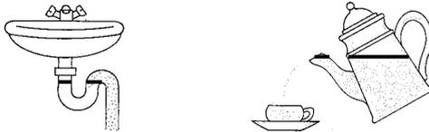
b) Lavabo: Der U-förmige Teil des Abfalls ist immer mit Wasser gefüllt, so ist er verschlossen und unangenehme Gerüche aus der Kanalisation können nicht in die Wohnung gelangen. Teekanne: Einschenken wird vereinfacht; die Flüssigkeitsoberfläche im Ausguss liegt auf gleicher Höhe wie im Innern der Kanne.
