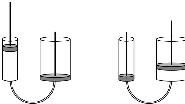
Das Volumen der umgefüllten Flüssigkeit bleibt gleich gross, darum steigt der rechte Kolben weniger hoch.
