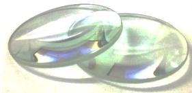
Eine Konvexlinse (oder Sammellinse) ist ein flacher durchsichtiger Körper (meistens aus Glas), der in der Mitte dicker ist als am Rand. Ein Beispiel für eine Konvexlinse ist eine Lupe. Die Lichtstrahlen werden beim Durchgang durch die Linse aufeinander zu gebrochen, d.h. «gesammelt».
