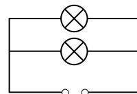
**Parallelschaltung:** Jedes Lämpchen hat seinen eigenen Stromkreis. Wenn ein Lämpchen durchbrennt, wird der Stromkreis nur für das betroffene Lämpchen unterbrochen.
