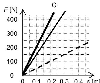
10. a)  $D$  wird doppelt so gross (die Kraft verteilt sich auf zwei Federn  $\rightarrow$  halbe Verlängerung bei gleicher Kraft  $\rightarrow$  doppelte Federkonstante)
